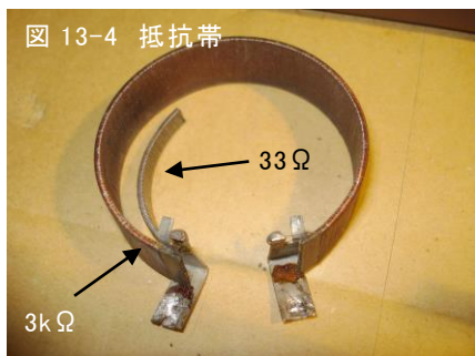
音量調節 可変抵抗器の構造
