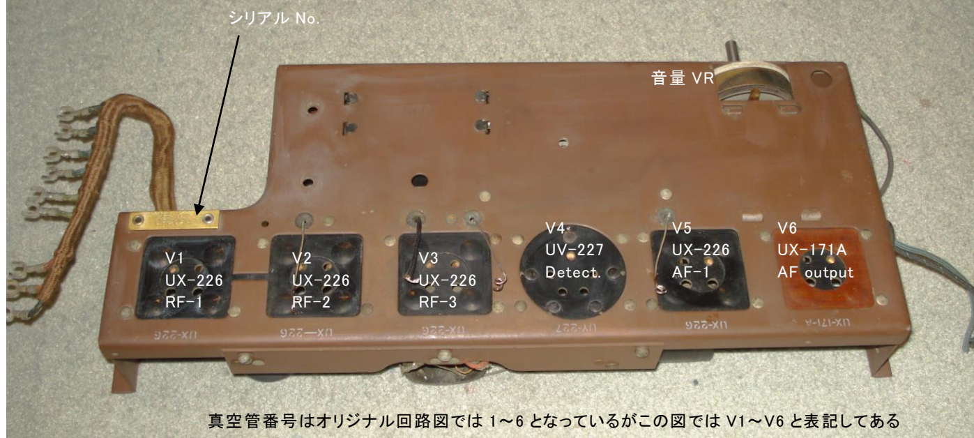
図 18 シャーシ上面（バリコン Assy を外した状態）
